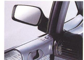
*Rétroviseurs extérieurs à réglage électrique en option.*
