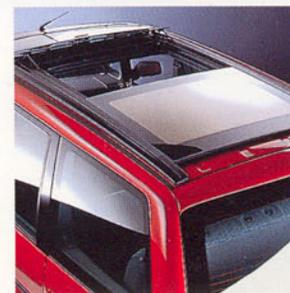
*Double toit ouvrant en option à commande manuelle avant et commande électrique arrière.*
