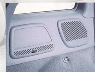
*Emplacement HP arrière et trappe d'accès rangement arrière.*
