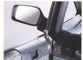
*Commande manuelle de rétroviseur extérieur.*
