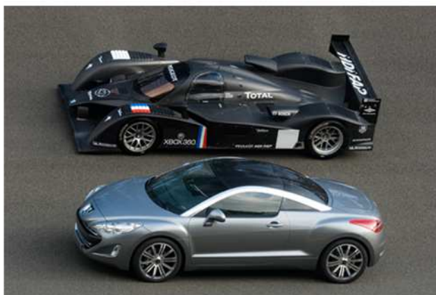
Un clin d'oeil à la 908 HDi FAP qui partage elle aussi le double bossage du toit de la 308 RC Z.
