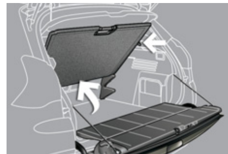
Depuis la position haute, placez le plancher dans cette position (en biais), deux butées le maintiennent afin d'accéder en dessous ou à la roue de secours.
