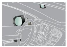
Équipés chacun d'un miroir réglable permettant la vision arrière latérale nécessaire aux situations de dépassement ou de stationnement. Peuvent également être rabattus pour stationner dans un passage étroit.
