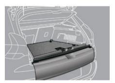
Ce plancher à trois positions vous permet d'optimiser le volume du coffre grâce aux guides placés sur les côtés :
