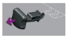
Sous le pare-chocs arrière, déclippez et retirez le cache de protection du support.
