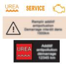
Dès la mise du contact, les témoins UREA, SERVICE et autodiagnostic moteur s'allument, accompagnés d'un signal sonore et de l'affichage du message "Défaut antipollution" pour signaler un défaut d'antipollution.
