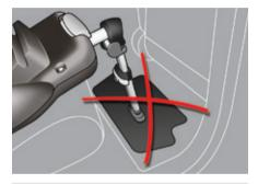
Ne placez pas la béquille sur le volet du coffre de rangement, il pourrait se casser lors d'un choc violent. Lorsque l'ajustement et les réglages de la béquille le permettent, nous vous proposons deux autres possibilités d'installation.
