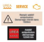
A chaque mise du contact, les témoins SERVICE et autodiagnostic moteur s'allument et le témoin UREA clignote, accompagnés d'un signal sonore et de l'affichage du message "Défaut antipollution : Démarrage interdit".
