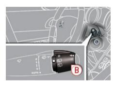
B. Bague de sélection de l'essuie-vitre arrière.
