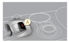
En cas de défaillance du freinage par la pédale de frein ou en situation exceptionnelle (exemple : malaise du conducteur, en conduite accompagnée, ...), un tirage maintenu de la palette A permet d'arrêter le véhicule. Le contrôle dynamique de stabilité (CDS) garantit la stabilité lors du freinage de secours. En cas de défaillance du freinage de secours.
