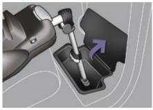
Si la béquille est assez longue, vous pouvez la mettre en contact avec le fond du coffre. Videz le coffre de tout objet avant l'installation de la béquille.
