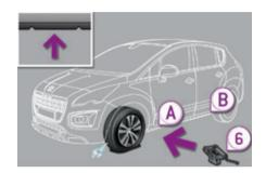
Positionnez la semelle du cric 6 au sol et assurez-vous que celle-ci soit à l'aplomb de l'emplacements avant A ou arrière B prévus sur le soubassement, le plus proche de la roue à changer.
