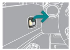
Tirez sur la commande de porte (avant ou arrière) pour ouvrir la porte ; celle-ci déverrouille complètement le véhicule.
