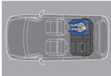
Lorsqu'un siège enfant "face à la route" est installé en **place passager arrière**, avancez le siège avant du véhicule et redressez le dossier de sorte que les jambes de l'enfant installé dans le siège enfant "face à la route" ne touchent pas le siège avant du véhicule.
