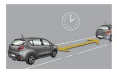
Pour le temps de sécurité à respecter, référezvous aux législations ou recommandations du code de la route en vigueur dans votre pays. Il fonctionne lorsque la vitesse de votre véhicule est supérieure à 70 km/h et inférieure à 150 km/h.
