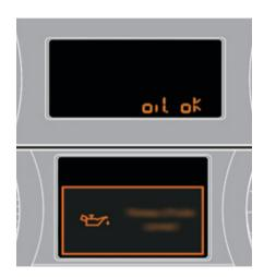
Toute vérification de ce niveau n'est valable que si le véhicule est sur un sol horizontal, moteur à l'arrêt depuis plus de 30 minutes.
