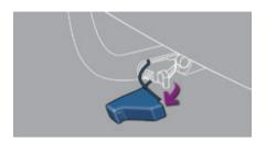
Déclippez et retirez le cache de protection, par un mouvement de rotation vers la droite.
