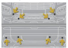
Système constitué de quatre capteurs de proximité, installés dans le pare-chocs avant et/ou arrière.
