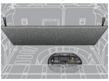
L'anneau de remorquage est installé dans le coffre sous le plancher.
