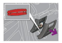
La pince d'extraction des fusibles est installée au dos du couvercle de la boîte à fusibles de planche de bord.
