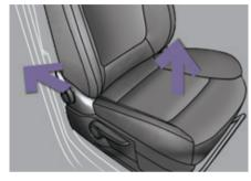
Siège passager réglé dans la position la plus haute et dans la position longitudinale arrière maximum
