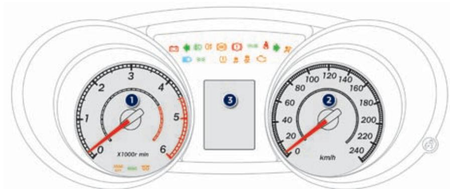
Panneau regroupant les cadrans et les témoins. Ceux-ci informant le conducteur de la mise en marche d'un système (témoins de marche ou de neutralisation) ou de l'apparition d'une anomalie (témoin d'alerte).
