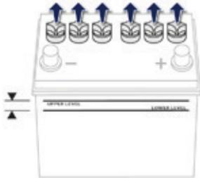
Pour vérifier ce niveau, vous devez retirer le couvercle de protection de la batterie (reportez-vous à la rubrique "batterie accessoires"). Le niveau de ce liquide doit se situer entre les repères MINI "LOWER LEVEL" et MAXI "UPPER LEVEL".
