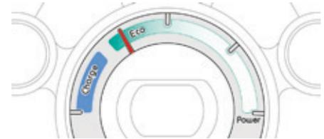
L'aiguille se situe dans cette zone lorsque le véhicule est utilisé de façon à modérer sa consommation électrique et à optimiser son autonomie.
