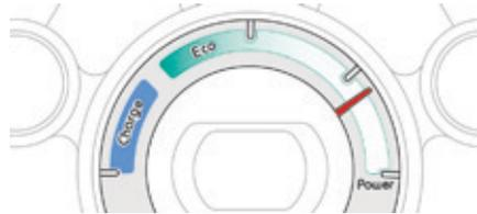
L'aiguille se déplace vers la droite proportionnellement à la consommation d'énergie du véhicule.
