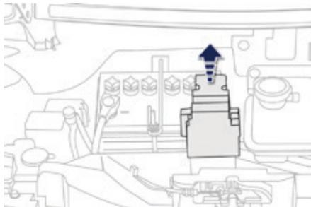
**!** Assurez-vous que l'électrolyte ne soit pas gelé. Vérifiez le niveau et faites le complément avec de l'eau distillée, si nécessaire (reportez-vous à la rubrique "vérifications des niveaux" de ce document).
