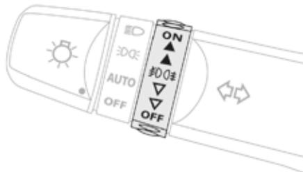
Bague de sélection des feux antibrouillard.
