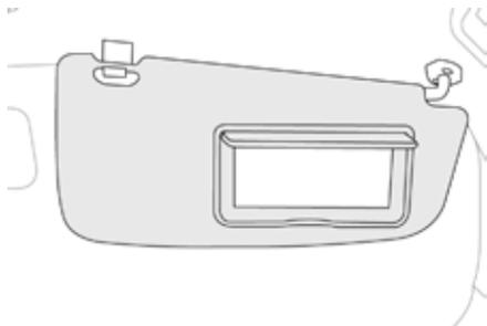
Les pare-soleil se déplient vers l'avant, et sur le côté lorsqu'ils sont décrochés.
