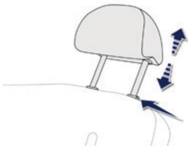
Ils ont une position haute (confort et meilleure sécurité) et une position basse (meilleure visibilité arrière pour le conducteur).
