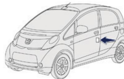
**!** Avant de réinitialiser le système, assurez-vous que la pression des quatre pneumatiques est adaptée aux conditions d'utilisation du véhicule et conforme aux préconisations inscrites sur l'étiquette de pression des pneumatiques. Le système de détection de sous-gonflage ne prévient pas si la pression est erronée au moment de la réinitialisation.
