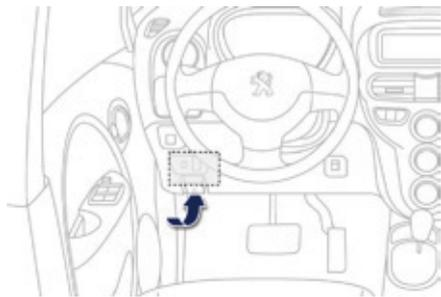
La pince d'extraction est fixée au dos du couvercle de la boîte à fusibles de la planche de bord (côté gauche).
