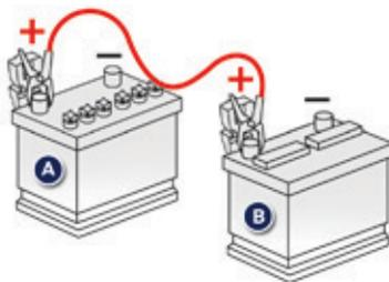
**!** Vérifiez bien que la batterie de secours est une batterie 12 V.
