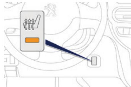
Appuyez sur l'interrupteur, placé sur la planche de bord, pour allumer le chauffage du siège conducteur.
