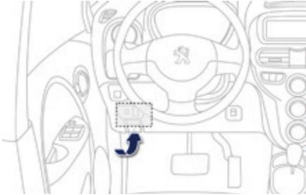
La boîte à fusibles est placée dans la partie inférieure de la planche de bord (côté gauche).
