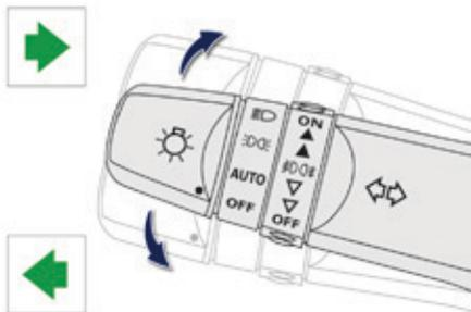
Dispositif de sélection des feux indicateurs de direction gauche ou droit pour signaler le changement de direction du véhicule.
