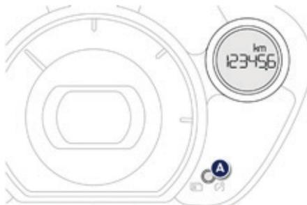
Système pour mesurer la distance totale parcourue par le véhicule pendant sa durée de vie.
