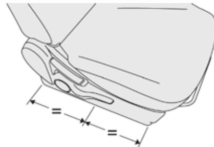
Siège passager réglé dans la position longitudinale intermédiaire.
