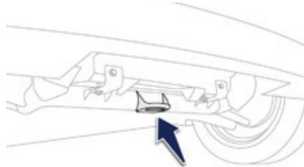
L'anneau de remorquage est soudé sur le châssis sous le pare-chocs avant.
