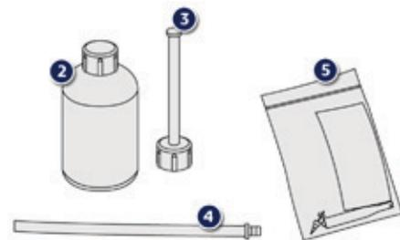
2. Flacon de produit de colmatage pour réparer temporairement la roue.
