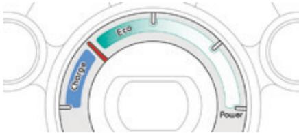
A la mise du contact, votre véhicule ne consomme ni ne génère d'énergie par sa chaîne de traction électrique : l'aiguille se trouve en position "neutre" (sous réserve de l'arrêt du chauffage ou de l'air conditionné).
