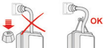
**!** Utilisez le cordon fourni pour accrocher le boîtier de contrôle, afin qu'il ne pèse pas sur la prise (risque de dégradation du câble de recharge ou de la prise électrique).
