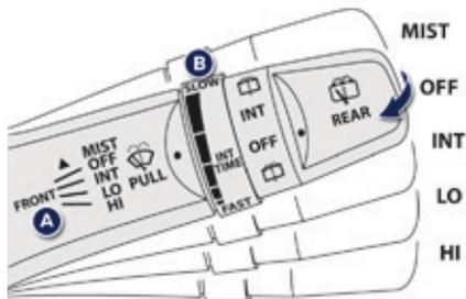
Les commandes d'essuie-vitres s'effectuent directement par le conducteur au moyen de la commande **A** et de la bague **B**.
