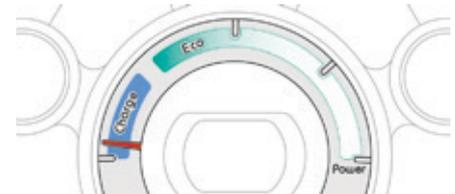
L'aiguille se déplace vers la gauche proportionnellement à la recharge de la batterie principale, pendant les périodes de décélération et de freinage.
