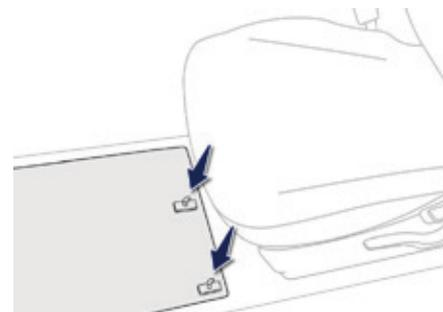
Lors du démontage du surtapis côté conducteur, reculez le siège au maximum et retirez les fixations.
