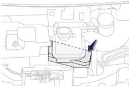
La boîte à fusibles est placée dans le compartiment avant, sous le réservoir du liquide du circuit de chauffage. Seuls ces fusibles peuvent être remplacés.
