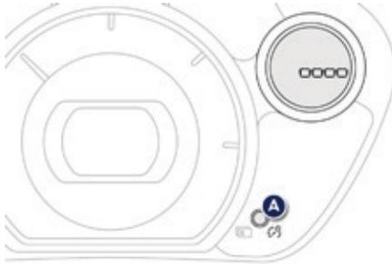
Système pour régler manuellement l'intensité lumineuse du poste de conduite en fonction de la luminosité extérieure.
