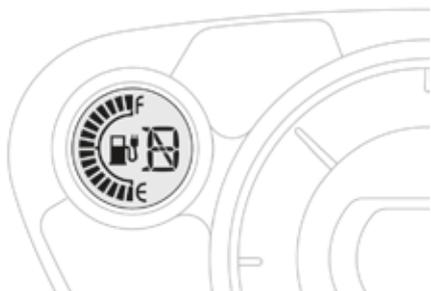
Le niveau de charge de la batterie principale est affiché en permanence dans le combiné.
