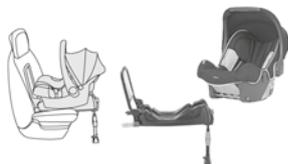
S'installe "dos à la route" à l'aide d'une base ISOFIX qui s'accroche aux anneaux **A**. La base comporte une béquille, réglable en hauteur, qui repose sur le plancher du véhicule. Ce siège enfant peut également être fixé à l'aide d'une ceinture de sécurité. Dans ce cas, seule la coque est utilisée et attachée au siège du véhicule par la ceinture de sécurité trois points.
