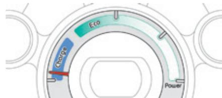
L'aiguille se déplace vers la gauche proportionnellement à la recharge de la batterie principale, pendant les périodes de décélération et de freinage.
