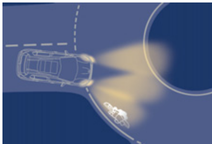
avec éclairage statique d'intersection
