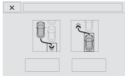
Le système apporte une assistance aux manœuvres d'entrée et de sortie de stationnement en créneau.
