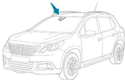
A l'aide d'un capteur laser situé en haut du pare-brise, ce système détecte un véhicule roulant dans le même sens de circulation ou se trouvant à l'arrêt devant le véhicule.
