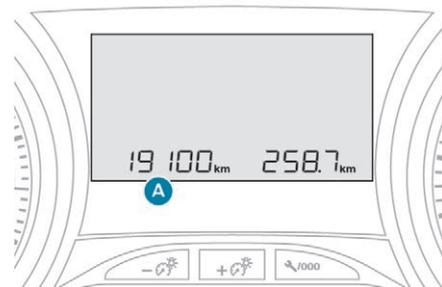
Système mesurant la distance totale parcourue par le véhicule pendant sa durée de vie. Le kilométrage total s'affiche dans la zone **A** de l'afficheur du combiné.
