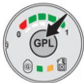
Contact mis, appuyez sur le commutateur pour que le calculateur gère l'activation du GPL. L'activation est alors mémorisée : en cas de coupure du moteur, le GPL sera activé au prochain démarrage.
