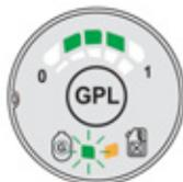
La LED orange est allumée, la LED verte clignote et, au-dessus, un certain nombre de LEDs vertes s'allument en fonction du niveau de GPL présent dans le réservoir GPL.
