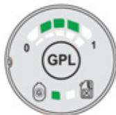
La LED verte cesse alors de clignoter, la LED orange s'éteint, un claquement de l'électrovanne se fait entendre au niveau du coffre, la commutation est réalisée.
