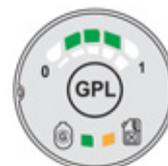
Le conducteur en est informé par un signal sonore et par l'allumage sur le commutateur de la LED orange (la LED verte et les LEDs vertes indiquant le niveau de GPL restent allumées). Le signal sonore peut être désactivé en appuyant sur le commutateur.
