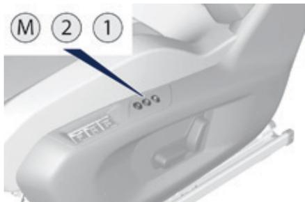
Système prenant en compte les réglages électriques du siège conducteur et des rétroviseurs extérieurs. Il vous permet de mémoriser et de rappeler deux positions à l'aide des touches sur le côté du siège conducteur.
