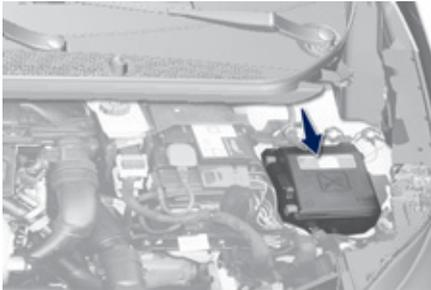
La boîte à fusibles est placée dans le compartiment moteur près de la batterie.
