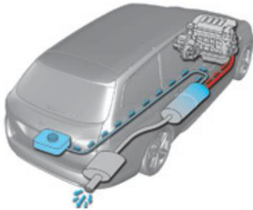
L'additif AdBlue® est contenu dans un réservoir spécifique, situé sous le coffre, à l'arrière du véhicule. Sa contenance est de 17 litres : elle permet une autonomie de roulage d'environ 20 000 km avant le déclenchement d'un dispositif d'alerte qui vous avertit dès que le niveau de réserve vous permet de parcourir 2 400 km.
