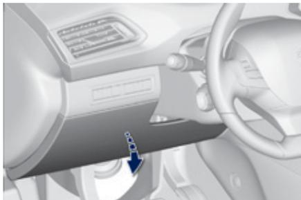
La boîte à fusibles est placée dans la partie inférieure de la planche de bord (côté gauche).
