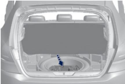
Les outillages sont installés dans le coffre sous le plancher.
