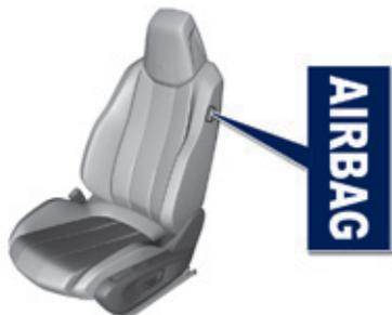
Système protégeant, en cas de choc latéral violent, le conducteur et le passager avant afin de limiter les risques de traumatisme au buste, entre la hanche et l'épaule. Chaque airbag latéral est intégré dans l'armature du dossier de siège, côté porte.
