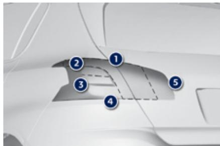
1. Feux de position (diodes électroluminescentes-LEDs).
