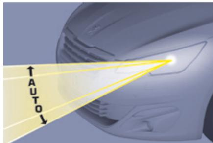
Pour ne pas gêner les autres usagers de la route, ce système corrige automatiquement la hauteur du faisceau des lampes "full leds", en fonction de la charge du véhicule.
