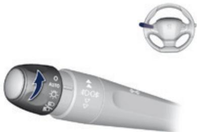
A l'aide d'un capteur de luminosité, en cas de détection d'une faible luminosité externe, les feux de plaque minéralogique, de position et de croisement s'allument automatiquement sans action du conducteur. Ils peuvent également s'allumer en cas de détection de pluie, en même temps que le balayage automatique des essuie-vitres avant.
