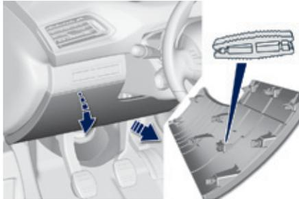
La pince d'extraction est fixée au dos du couvercle de la boîte à fusibles de planche de bord.
