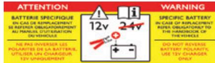
**!** La présence de cette étiquette, notamment avec le Stop & Start, indique l'utilisation d'une batterie au plomb 12 V de technologie et de caractéristiques spécifiques, qui nécessite, en cas de débranchement ou de remplacement, l'intervention exclusive du réseau PEUGEOT ou d'un atelier qualifié.
