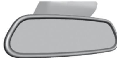
Grâce à un capteur, mesurant la luminosité provenant de l'arrière du véhicule, ce système assure automatiquement et progressivement le passage entre les utilisations jour et nuit.
