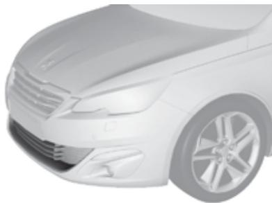
**i** Le fonctionnement du radar, situé dans le pare-chocs avant, peut être perturbé dans certaines conditions climatiques, exemples : accumulation de neige, de glace, de boue, ...
