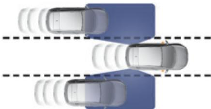
Ce système d'aide à la conduite avertit le conducteur de la présence d'un autre véhicule dans les zones d'angle mort de son véhicule (zones masquées du champ de vision du conducteur), dès lors que celle-ci présente un danger potentiel.
