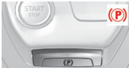
Ce système permet le serrage du frein de stationnement à l'arrêt du moteur et le desserrage dès la mise en mouvement du véhicule.
