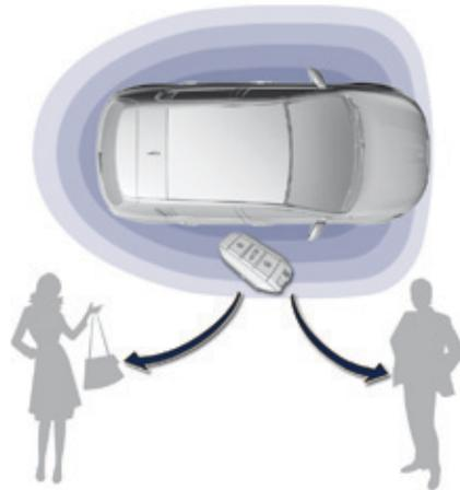
Système permettant l'ouverture, la fermeture et le démarrage du véhicule en gardant la clé électronique sur soi.
