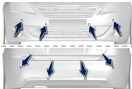
A l'aide de capteurs situés dans le pare-chocs, cette fonction vous signale la proximité de tout obstacle (personne, véhicule, arbre, barrière...) qui entre dans leur champ de détection. Certains types d'obstacle (piquet, balise de chantier...) détectés au début ne le seront plus en fin de manœuvre en raison de la présence de zones aveugles.
