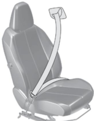
Les ceintures de sécurité avant sont équipées d'un système de prétension pyrotechnique et de limiteur d'effort.
