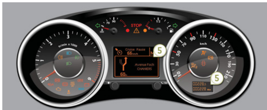
Panneau regroupant les cadrans et les témoins d'indication de fonctionnement du véhicule.
