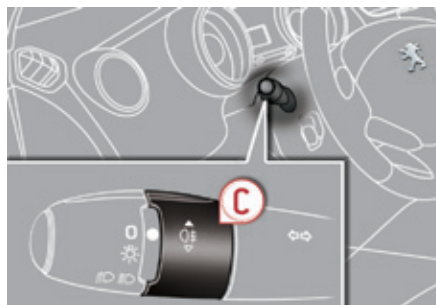
Modèle avec feu antibrouillard arrière seul
