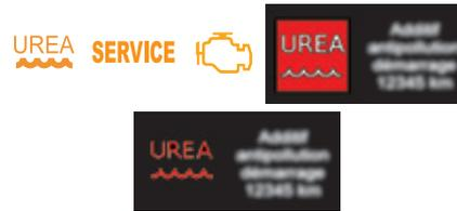
Dès la mise du contact, les témoins UREA, SERVICE et autodiagnostic moteur s'allument, accompagnés d'un signal sonore et de l'affichage du message "Défaut antipollution" pour signaler un défaut d'antipollution.
