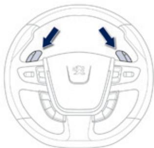
Ce changement de vitesses ponctuel permet d'effectuer un dépassement, par exemple, tout en restant en mode automatisé.
