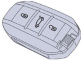
Système permettant l'ouverture, la fermeture et le démarrage du véhicule en gardant la clé électronique sur soi. Il peut également être utilisé comme une télécommande.
