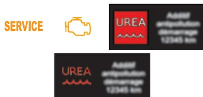
A chaque mise du contact, les témoins SERVICE et autodiagnostic moteur s'allument et le témoin UREA clignote, accompagnés d'un signal sonore et de l'affichage du message "Défaut antipollution : Démarrage interdit".
