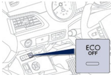
En cas de dysfonctionnement du système, le voyant de la commande "ECO OFF" clignote, puis s'allume fixement.
