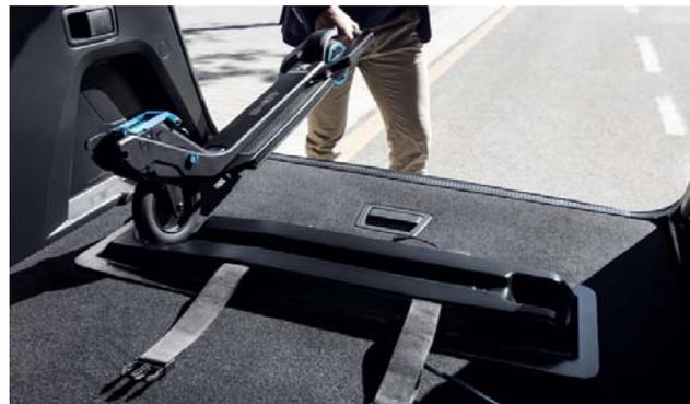
Une station d'accueil, la « **dockstation** », permet de ranger l'e-Kick dans le coffre du nouveau SUV PEUGEOT 3008, tout en assurant la recharge de la batterie dès que le véhicule est en marche. Elle peut être positionnée librement sur le plancher de coffre.
