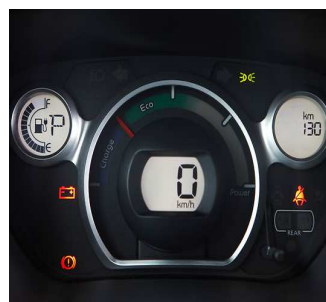
Indicateur de consommation ou régénération d'énergie
