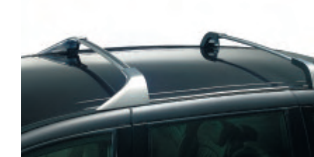
Barres de toit Fluides et aérodynamiques, les barres de toit 807 coulisent dans les rails du pavillon (selon version).
