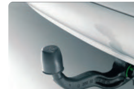
Attelage à rotule démontable sans outil Un simple geste permet d'enclencher ou d'éjecter la rotule de son boîtier: 807 retrouve alors sa ligne d'origine.
