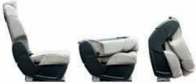
Repli intégral des sièges arrière en position "portefeuille" afin d'en faciliter la dépose ainsi que l'accès à bord.
