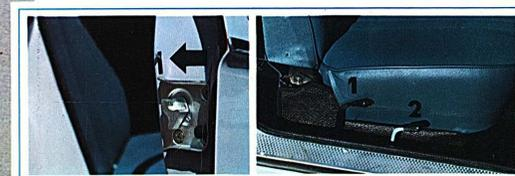
Aux portes AR, un dispositif de sécurité pour les enfants interdit l'ouverture de l'intérieur.
