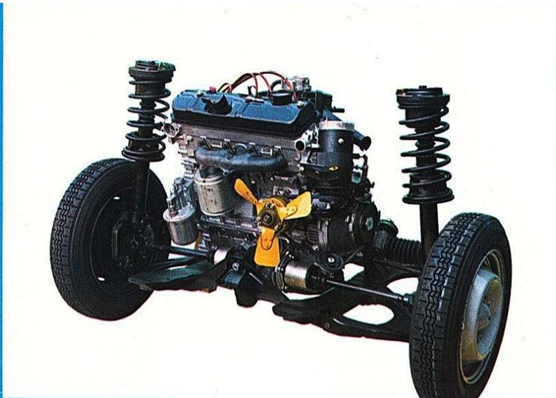
Le moteur de la 204 est du type super-carré de 1 130 cm<sup>3</sup>, 75x64, d'une puissance fiscale de 6 CV, développant 58 ch SAE à 5.800 tr/mn, et permet une vitesse de pointe de 138 km/h.
