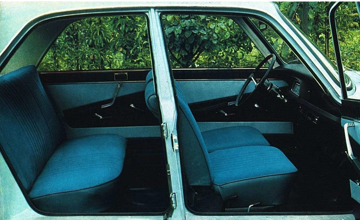
Les portes AV possèdent une serrure extérieure à clé, et les portes AR un dispositif de sécurité pour les enfants, interdisant l'ouverture de l'intérieur. La garniture des portes, d'une découpe élégante et nouvelle, est habillée de simili inaltérable deux tons. Un cendrier est encastré dans chacune des portes AR des modèles grand luxe.
