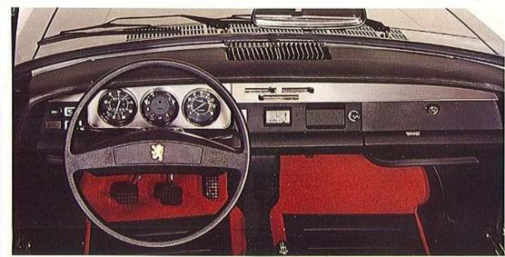
Ceux qui s'attachent à la ligne et au confort du Cabriolet et du Coupé 304 retrouvent cette même élégance et ce même raffinement dans les modèles S avec, en plus, des équipements nouveaux et originaux : levier de changement de vitesses au plancher, compte-tours, appuis-tête amovibles utilisables en position conduite ou position repos, garnitures de sièges en Teppline (\*).
