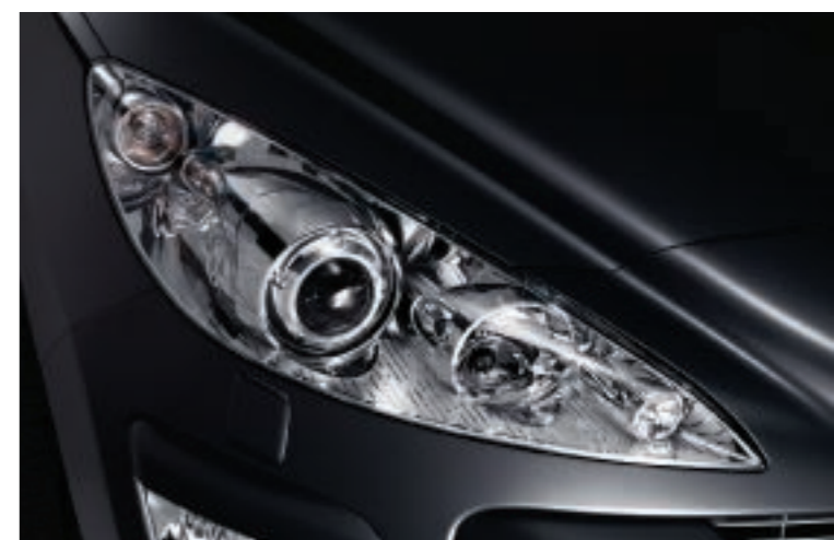
Les projecteurs directionnels* pivotent en fonction de l'angle du volant et de la vitesse du véhicule.
