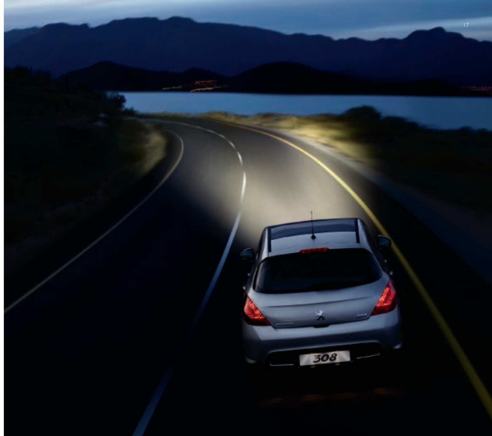
Les projecteurs directionnels* pivotent en fonction de l'angle du volant et de la vitesse du véhicule.
