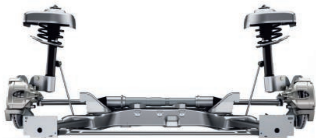
Elargies, les voies du châssis de Peugeot 308 accroissent sa stabilité et améliorent sa tenue de route.
