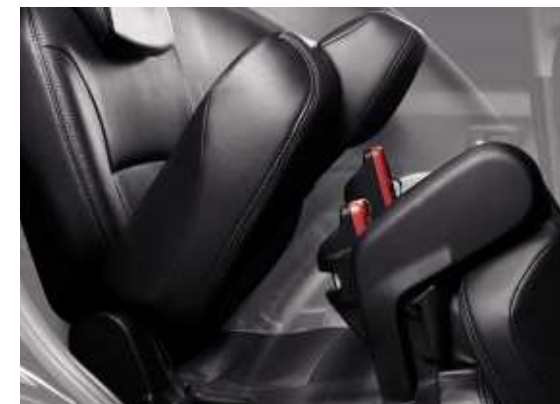
Les sièges arrière sont coulissants, inclinables et repliables.
