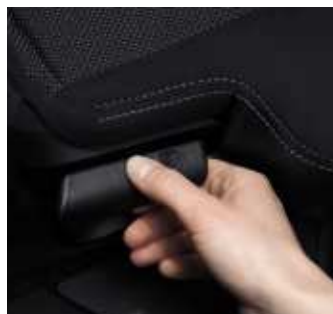
Une palette commande la manipulation du siège arrière.
