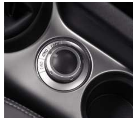
Commande manuelle du mode de transmission.
