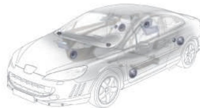
L'obstacle est alors matérialisé par un signal sonore et par un affichage sur l'écran multifonction couleur.
