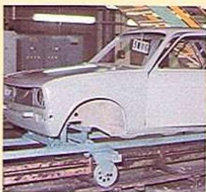
**6 APPRÊT :** Le support de la laque renferme des pigments inhibiteurs de rouille (chromates de zinc) qui améliorent encore la protection anticorrosion. Cet apprêt spécial souple comporte également une fonction antigravillonnage.
