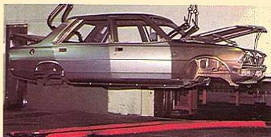
**1 TOLE :** Certains éléments de la carrosserie difficiles à protéger et très sensibles à la corrosion sont réalisés en tôles électrozinguées ou galvanisées. Sur tous les éléments de la carrosserie, les graisses d'emboutissage préjudiciables à l'accrochage des revêtements de protection sont éliminées.
