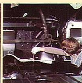
**4 JOINTS D'ÉTANCHEITÉ :** Les cordons de mastic posés au niveau des jonctions entre tôles tant à l'intérieur qu'à l'extérieur de la caisse assurent une étanchéité maximum.
