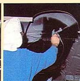
**5 REVÊTEMENT PLASTIQUE (PVC) :** Cuit au four, il assure la protection des parties de la caisse soumises au gravillonnage (épaisseur : environ 1 à 2 mm).
