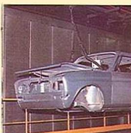
**2 PHOSPHATATION AU FER :** Elle protège des chocs et de l'écaillage et améliore l'accroche du film de résine dans le bain cataphorétique. Certains corps creux sont lavés et phosphatés avant l'assemblage de la caisse.
