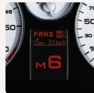
Le rapport de vitesses engagé est indiqué sur l'afficheur à matrice de points.
