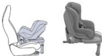
S'installe "dos à la route" à l'aide d'une base ISOFIX qui s'accroche aux anneaux **A**. La base comporte une béquille, réglable en hauteur, qui repose sur le plancher du véhicule. Ce siège enfant peut également être utilisé en "face à la route". Ce siège enfant **ne peut pas** être fixé à l'aide d'une ceinture de sécurité. Nous vous recommandons d'utiliser le siège orienté "dos à la route" jusqu'à 3 ans.
