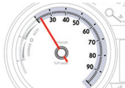
Zone qui indique une augmentation de la **sollicitation de puissance** cumulée de votre véhicule hybride, tenant compte des capacités combinées du moteur Diesel et du moteur électrique.
