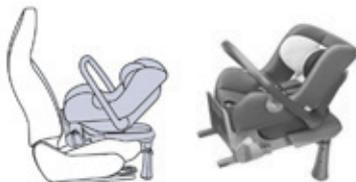
S'installe "dos à la route" à l'aide d'une base ISOFIX qui s'accroche aux anneaux **A**. La base comporte une béquille, réglable en hauteur, qui repose sur le plancher du véhicule. Ce siège enfant peut également être fixé à l'aide de la ceinture de sécurité. Dans ce cas, seule la coque est utilisée.
