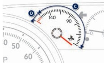
A la mise du contact ou véhicule roulant, il indique la température d'huile moteur.
