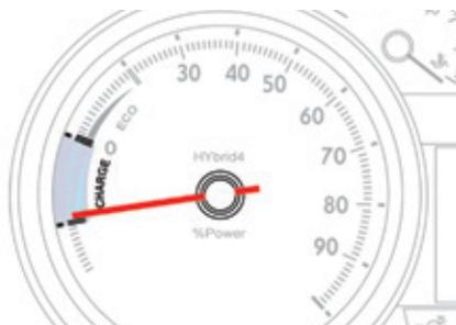
Zone qui indique que le véhicule est en phase de **récupération d'énergie** électrique : en décélération, freinage (partiellement) et surtout en levé de pied (à privilégier au freinage car meilleure récupération).
