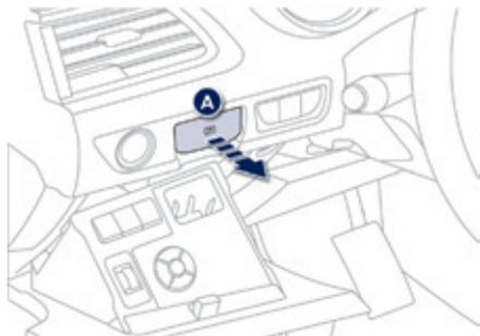
En cas de défaillance du freinage par la pédale de frein, un tirage maintenu de la palette **A** permet d'arrêter le véhicule.
