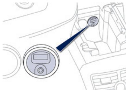
Ce boîtier de connexion est composé d'une prise JACK et USB.
