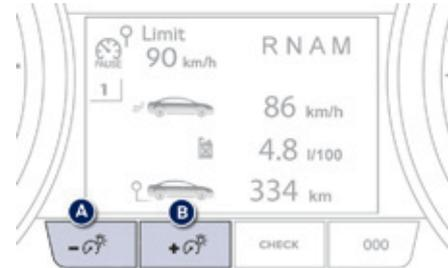
Feux allumés, appuyez sur le bouton **B** pour augmenter l'intensité de l'éclairage du poste de conduite et d'ambiance du véhicule ou sur le bouton **A** pour la diminuer.
