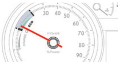
Zone qui indique que le véhicule **optimise sa consommation de carburant** en électrique, en Diesel ou en combinant les deux.
