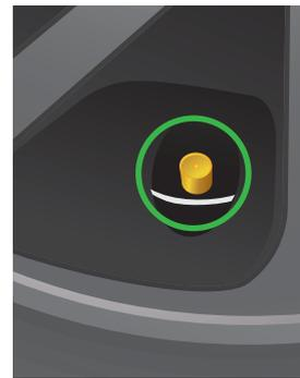
Position **conforme** de la valve : au dessus de l'anneau.
