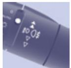
La sélection s'effectue par rotation de cette bague à impulsion vers l'avant pour allumer et vers l'arrière pour éteindre.
