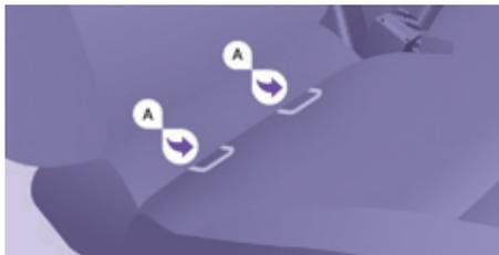
Deux anneaux avant **A**, situés entre le dossier et l'assise du siège du véhicule, signalés par un marquage.
