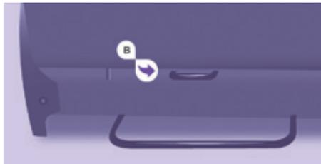
Un anneau arrière **B**, situé au dos du dossier du siège du véhicule, pour la fixation de la sangle haute appelée Top Tether.
