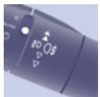
Pour éteindre les feux antibrouillard arrière et les projecteurs antibrouillard avant, tournez la bague deux fois de suite vers l'arrière.
