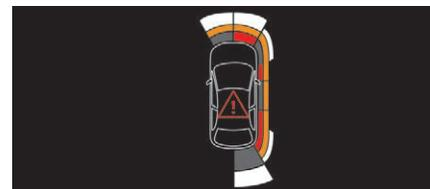
A l'aide de quatre capteurs supplémentaires aménagés sur les côtés des pare-chocs avant et arrière, le système enregistre la position des obstacles fixes au cours de la manoeuvre et les signale lorsqu'ils sont situés au niveau des côtés du véhicule.
