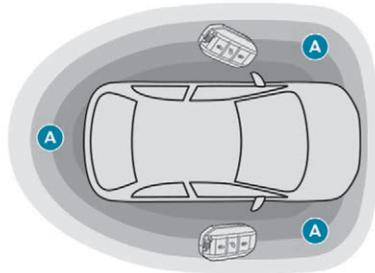
Système permettant le déverrouillage, le verrouillage et le démarrage du véhicule en gardant la clé électronique dans la zone de reconnaissance **A**.
