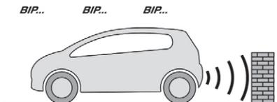
La fonction signale la présence des obstacles présents à la fois dans la zone de détection des capteurs et dans la trajectoire du véhicule définie par l'orientation du volant.
