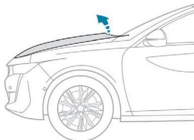
Le capot actif a été conçu pour optimiser la sécurité des piétons en cas de choc avec l'avant du véhicule.
