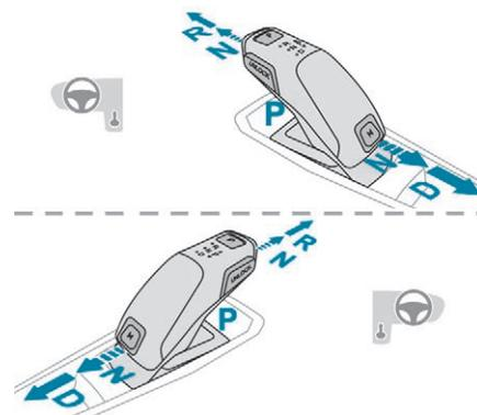
Basculez le sélecteur en donnant une ou deux impulsions vers l'avant (**N** ou **R**) ou vers l'arrière (**N** ou **D**), en franchissant, si nécessaire, le point de résistance. Dès que vous relâchez le sélecteur impulsif, il revient à sa position initiale.
