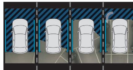
A l'aide d'une ou de deux caméras, les alentours proches du véhicule sont enregistrés pendant les manoeuvres à basse vitesse.
