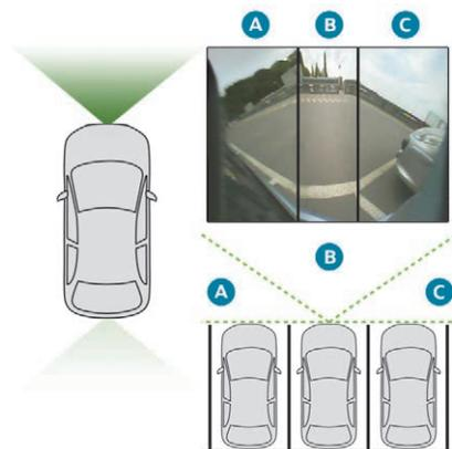
La vue à 180° permet de pouvoir sortir, en marche avant, d'une place de stationnement en anticipant l'arrivée de véhicules, cyclistes ou piétons.
