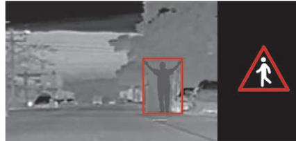
L'image fournie par la caméra s'affiche en niveaux de gris au combiné, les objets chauds apparaissant plus clairs que les objets froids. Dès que des piétons ou des animaux sont détectés, ils apparaissent encadrés de jaune.
