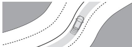
A l'aide d'une caméra placée sur la partie supérieure du pare-brise, le système identifie les délimitations de la voie de circulation et pilote le véhicule à l'intérieur de cette voie pour le maintenir dans la position latérale choisie par le conducteur.
