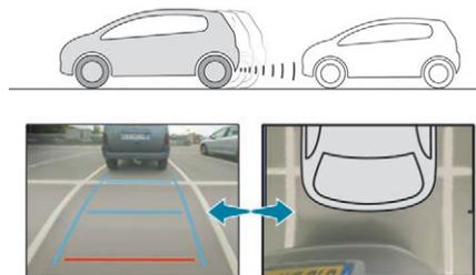
Ce mode est activé par défaut. À l'aide des capteurs situés sur le pare-chocs arrière, la vue automatique permet de passer de la vue arrière (standard) à la vue de dessus (zoom) à l'approche d'un obstacle au niveau de la ligne rouge (moins de 30 cm) lors de la manoeuvre.
