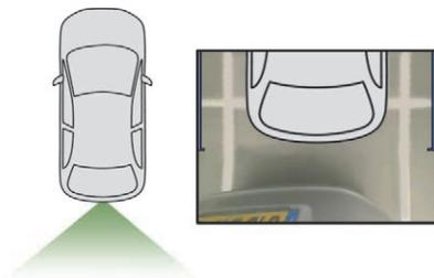
La caméra enregistre les alentours lors de la manoeuvre pour créer une vue de dessus arrière du véhicule dans son environnement proche, permettant de réaliser une manoeuvre du véhicule avec les obstacles environnants. Cette vue est disponible avec le mode AUTO ou par sélection dans le menu de changement de vue.
