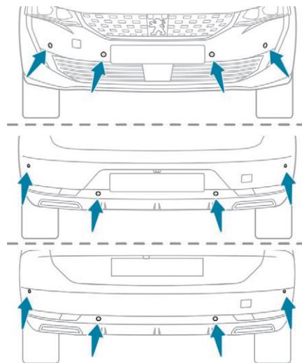
À l'aide de capteurs situés dans le pare-chocs, cette fonction signale la proximité d'obstacles (ex. : piéton, véhicule, arbre, barrière) qui entrent dans leur champ de détection.
