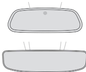
Grâce à un capteur, mesurant la luminosité provenant de l'arrière du véhicule, ce système assure automatiquement et progressivement le passage entre les utilisations jour et nuit.
