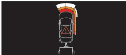
**i** La fonction aide au stationnement arrière sera neutralisée automatiquement en cas de branchement d'une remorque ou d'un porte-vélo sur un dispositif d'attelage installé selon les préconisations du constructeur.
