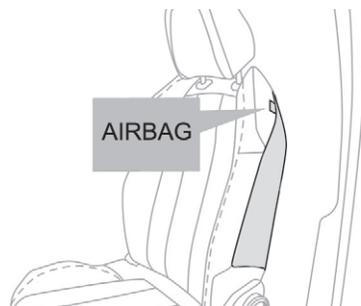
Système protégeant, en cas de choc latéral violent, le conducteur et le passager avant afin de limiter les risques de traumatisme au buste, entre la hanche et l'épaule. Chaque airbag latéral est intégré dans l'armature du dossier de siège, côté porte.
