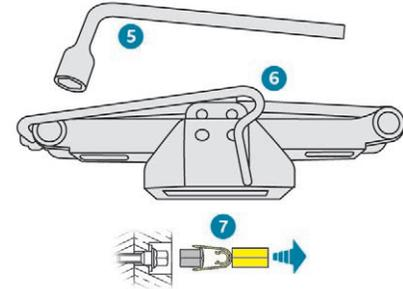
5. Clé démonte-roue. Permet la dépose de l'enjoliveur et la dépose des vis de fixation de la roue.
