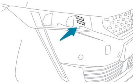
En feux de croisement ou en feux de route, cette fonction permet au feu avant d'éclairer l'intérieur du virage à l'aide de diodes électroluminescentes (LED).
