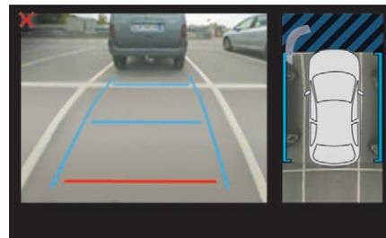
Pour aider le conducteur à surveiller le bon déroulement de la manœuvre, le système déclenche automatiquement l'affichage du Visiopark 1 ou du Visiopark 2 et l'activation de l'aide au stationnement.
