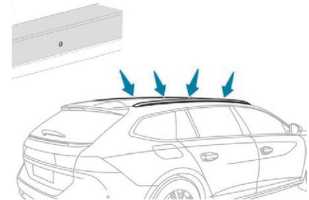
Les barres transversales doivent être fixées au niveau des repères gravés sur les barres longitudinales.
