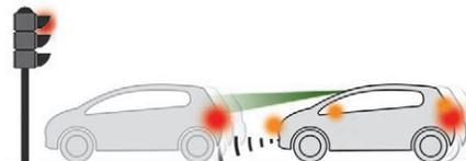
Cette fonction, aussi appelée freinage automatique d'urgence, intervient après les alertes, si le conducteur ne réagit pas assez vite et n'actionne pas les freins du véhicule. Elle a pour objectif de réduire la vitesse d'impact ou d'éviter la collision de votre véhicule en cas de non-intervention du conducteur.
