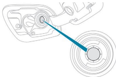
Lors de son introduction dans votre réservoir Diesel, le pistolet essence vient buter sur le volet. Le système reste verrouillé et empêche le remplissage.
