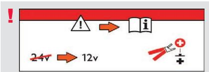
En présence de cette étiquette, il est impératif d'utiliser uniquement un chargeur 12 V, au risque de provoquer la dégradation irréversible des équipements électriques liés au Stop & Start.
