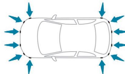
Le système effectue les mesures de places de stationnement disponibles et les calculs de distances par rapport aux obstacles à l'aide de 12 capteurs à ultrasons implantés dans les pare-chocs avant et arrière du véhicule.
