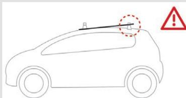
N'ouvrez pas le toit ouvrant lors de l'utilisation des barres de toit - Risque de détérioration importante !
