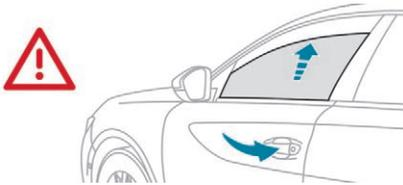
La vitre remonte automatiquement au bout de quelques secondes et s'ajuste pour assurer une parfaite étanchéité à la fermeture.
