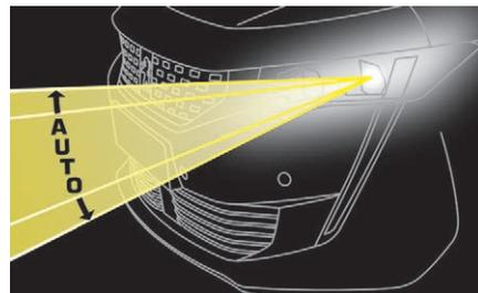
Pour ne pas gêner les autres usagers de la route, ce système corrige automatiquement la hauteur du faisceau de ce type de projecteurs, en fonction de la charge du véhicule.
