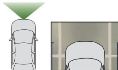
La caméra enregistre les alentours lors de la manoeuvre pour créer une vue de dessus avant du véhicule dans son environnement proche, permettant de réaliser une manoeuvre du véhicule avec les obstacles environnants. Cette vue est disponible avec le mode AUTO ou par sélection dans le menu de changement de vue.
