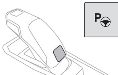
Pendant toute la durée de la manœuvre automatique, le conducteur doit impérativement maintenir l'appui sur le bouton de contrôle de la fonction implanté sur le sélecteur de la boîte de vitesses.
