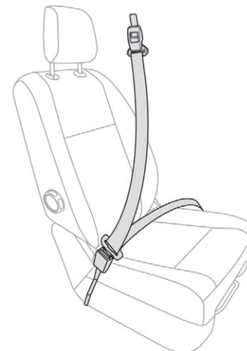
Les ceintures de sécurité avant sont équipées d'un système de prétension pyrotechnique et de limiteur d'effort.
