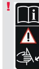
Ne **jamais** placer la main sous l'assise pour accompagner le siège à la remontée, risque de pincement des doigts. Seule la sangle doit être utilisée.
