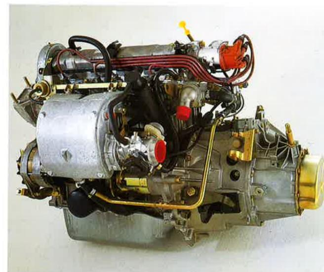
électronique détermine la quantité optimale de carburant en fonction des informations reçues de différents capteurs. La décélération provoque une coupure automatique d'alimentation pour tous les régimes supérieurs à 1600 tr/mn.
