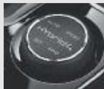
**AUTO\*** L'électronique gère automatiquement l'ensemble du système notamment les transitions entre les moteurs Diesel et électrique. Le mode AUTO est à privilégier pour obtenir un fonctionnement optimal entre consommation maîtrisée et prestations dynamiques.
