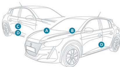
**A. Numéro d'identification véhicule (V.I.N.), sous le capot moteur.**
