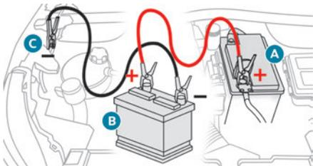
► Soulever le cache plastique de la borne (+), si le véhicule en est équipé.
