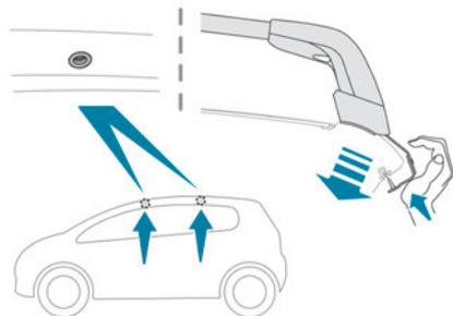
Les barres transversales doivent être fixées exclusivement aux quatre points d'ancrage situés sur le cadre de pavillon. Ces points sont masqués par les portes du véhicule lorsqu'elles sont fermées.
