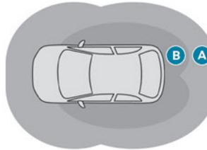
**Zone A** : verrouillage automatique à l'éloignement (2 mètres du véhicule environ).
