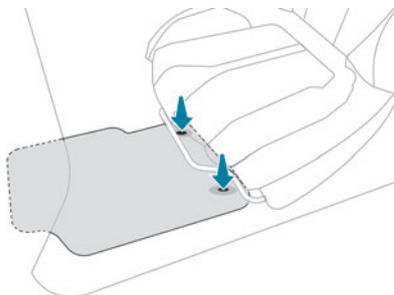
Lors de son montage, côté conducteur, utiliser exclusivement les fixations présentes sur le tapis (un "clac" signale le bon verrouillage). Les autres surtapis sont simplement posés sur la moquette.
