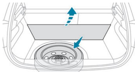
La roue de secours est installée sous le tapis de coffre.
