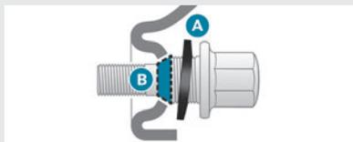
Dans le cas des roues aluminium, les rondelles **A** ne viennent pas en contact avec la roue de secours tôle ou de type "galette". Le maintien de la roue se fait par l'appui conique **B** de chaque vis.
