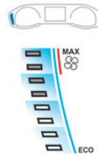
La jauge représente la consommation d'énergie électrique de la batterie de traction liée au confort thermique dans l'habitacle.
