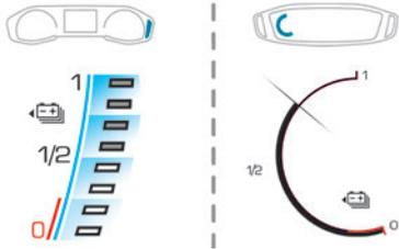
Le niveau de charge réel de la batterie de traction et l'autonomie restante sont affichées en permanence lorsque le véhicule est démarré.
