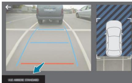
Pour activer la caméra, située sur le hayon, engager la marche arrière et ne pas dépasser la vitesse de 10 km/h.
