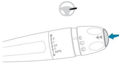
► Appuyer sur le bouton situé à l'extrémité de la commande d'essuie-vitre pour afficher successivement les onglets suivants :
