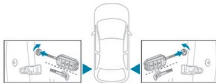
► Pour verrouiller, tourner la clé intégrée dans la commande **rouge** jusqu'en butée :
