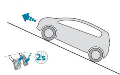
**En pente montante, véhicule à l'arrêt, le véhicule est maintenu un court instant dès que le conducteur relâche la pédale de frein :**
