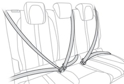
Les places arrière sont équipées chacune d'une ceinture, dotée de trois points d'ancrage et d'un enrouleur.
