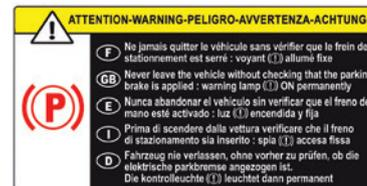
**!** Avant de sortir du véhicule, vérifier que le frein de stationnement est serré : les témoins de frein de stationnement doivent être allumés fixe au combiné et sur la commande.
