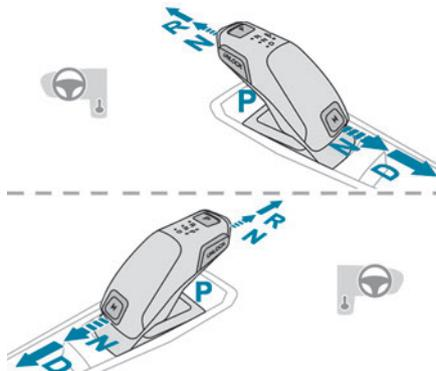
► Basculer le sélecteur en donnant une ou deux impulsions vers l'avant (**N** ou **R**) ou vers l'arrière (**N** ou **D**), en franchissant, si nécessaire, le point de résistance.
