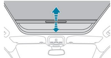
► Prendre le rideau par sa poignée et le tirer vers l'arrière / l'avant pour l'ouvrir / le fermer jusqu'à la position désirée.
