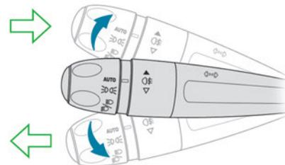
► Gauche ou droit : abaisser ou relever la commande d'éclairage en dépassant le point de résistance.
