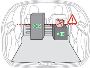
**!** Ne pas placer d'objets au-dessus de l'arrêt de charge.
