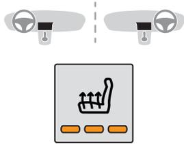
La fonction est active uniquement moteur tournant, lorsque la température extérieure est inférieure à 20 °C.
