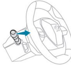
► Contact coupé, tirer la commande d'éclairage ("appel de phares") pour mettre en service / arrêter la fonction.
