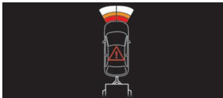
**i** La fonction aide au stationnement arrière sera désactivée automatiquement en cas de branchement d'une remorque ou d'un porte-vélo sur un dispositif d'attelage installé selon les préconisations du constructeur. Dans ce cas, le dessin d'une remorque s'affiche à l'arrière de la représentation du véhicule.
