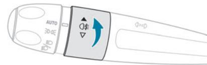
► Tourner la bague vers l'avant / l'arrière pour l'allumer / l'éteindre.
