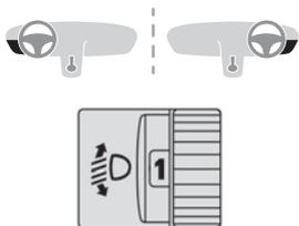
Pour ne pas gêner les autres usagers de la route, le faisceau de ces projecteurs doit être réglé en hauteur en fonction de la charge du véhicule.
