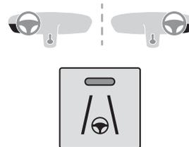
► Avec le Régulateur de vitesse adaptatif avec fonction Stop & Go activé, appuyer sur ce bouton.
