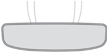
Le système électrochrome utilise un capteur qui prend en compte le niveau de luminosité extérieure, et celui provenant de l'arrière du véhicule, pour assurer automatiquement et progressivement le passage entre les utilisations jour et nuit.
