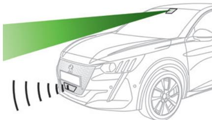
Le véhicule comporte une caméra multifonction implantée en haut du pare-brise et, selon version, un radar situé dans le pare-chocs avant.
