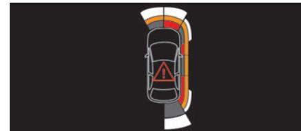
À l'aide de 4 capteurs supplémentaires aménagés sur les côtés des pare-chocs, le système enregistre la position des obstacles au cours de la manœuvre et les signale lorsqu'ils sont situés au niveau des côtés du véhicule.
