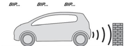
Le système signale la présence d'obstacles dans la zone de détection des capteurs.
