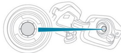
Lors de l'introduction dans le réservoir Diesel, le pistolet essence vient buter sur le volet. Le système reste verrouillé et empêche le remplissage.
