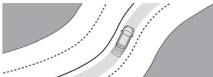
Le système identifie les délimitations de la voie de circulation et pilote le véhicule à l'intérieur de cette voie pour le maintenir dans la position latérale choisie par le conducteur. Pour cela, le système utilise une caméra placée sur la partie supérieure du pare-brise. Cette fonction est principalement adaptée à la conduite sur autoroutes et voies rapides.
