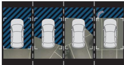
À l'aide de la caméra arrière, les alentours proches du véhicule sont enregistrés pendant les manœuvres à basse vitesse.
