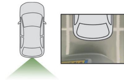
La caméra enregistre les alentours lors de la manœuvre pour créer une vue de dessus arrière du véhicule dans son environnement proche, permettant de réaliser une manœuvre du véhicule avec les obstacles environnants.
