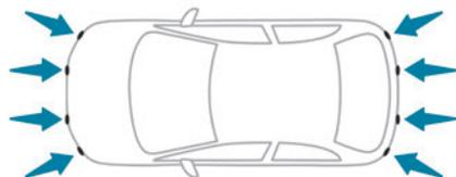
Ce système détecte et signale la proximité d'obstacles (ex. : piéton, véhicule, arbre, barrière) à l'aide de capteurs situés dans le pare-chocs.
