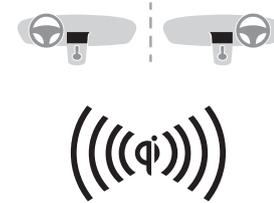
Ce système recharge sans fil des appareils nomades tels que les smartphones, en utilisant le principe de l'induction magnétique, selon la norme Qi 1.1.
