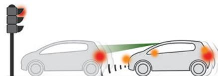
Ce système, aussi appelé freinage automatique d'urgence, intervient après les alertes, si le conducteur ne réagit pas assez vite et n'actionne pas les freins du véhicule.
